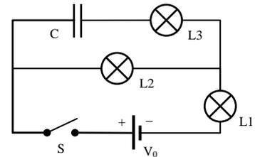
a) Der Schalter S wird nun geschlossen. Der Strom durch die Lampe L1 sei dann  $I_1$  und bleibt konstant. Zeichnen Sie qualitativ die Zeit – Stromkurve  $I_2$  und  $I_3$  der Lampen 2 und 3 im richtigen Verhältnis zu  $I_1$  in den untenstehenden Graphen ein.
