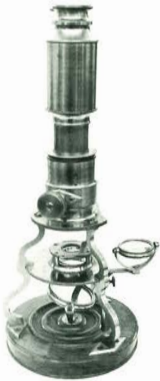
Mikroskop nach Marshall, Baujahr um 1700 (Foto L. Fischer).
